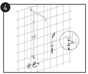
确保花洒软管(8)的两端都带有密封垫片(7)。将花洒软管的一端连接花洒(6),另一端连接淋浴杆花洒连接头(9)。打开冷热水,检查弯头接口及软管两端是否漏水。
