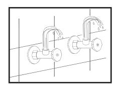
打开冷热供水,排水管内积累的残渣。否则将有损龙头。
