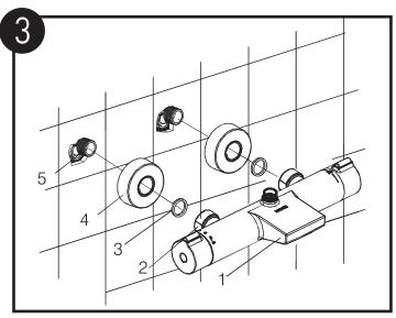
将法兰罩(4)穿入弯头(5),使法兰罩与墙壁平齐。 将垫圈(3)放入阀体上的连接 螺母(2)内,并用扳手将连接螺母与弯头拧紧。
