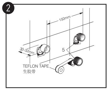
用生胶带缠上弯头(5)较小的一头,然后 接上供水管。 要有足够的生胶带以密封 弯头与出水管间的连接处。 调整两弯头 位置水平,相距150mm,并凸出墙面 30-32mm。
